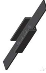
Рис. 1. Повна геометрична модель зразка для випробування на втому болтового з'єднання з ПКМ
