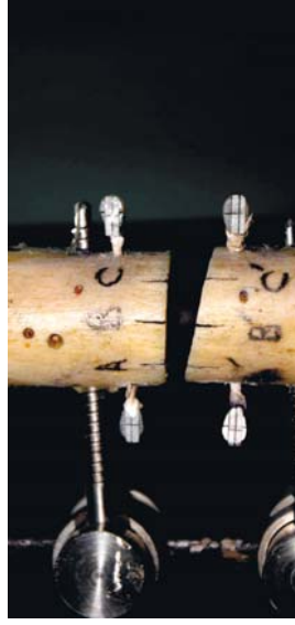
Рис. 1. Зразок великоомілкової кістки з мольованим переломом, закріпленим стержневим апаратом зовнішньої фіксації та з встановленими реперними елементами
